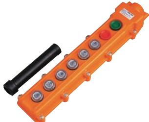
COB 系列按钮适用于交流 50Hz 或 60Hz、电压至 380V，直流工作电压至 220V 的电路控制系统中。适用于露天，有雨雪、多尘埃侵害环境，如起重机、电动葫芦等设备的远程控制之用。
