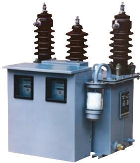
JLS-6、10型组合互感器(以下简称组合互感器)适用于户外、频率为50Hz,电压为6kV、10 kV电力系统中有功和无功电能计量。
