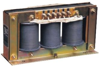
本型电压互感器为三相五柱干式户内型产品，适用于交流50Hz、500V及以下、中性点非有效接地三相电力系统中做电压、电能测量及继电保护用。
